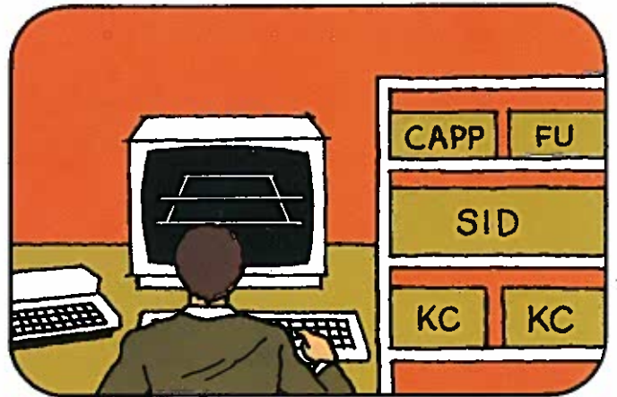
9. Ved hjælp af afprøvningsudstyret gennemføres en trafikal og betjeningsmæssig afprøvning af sikringsanlægget.
