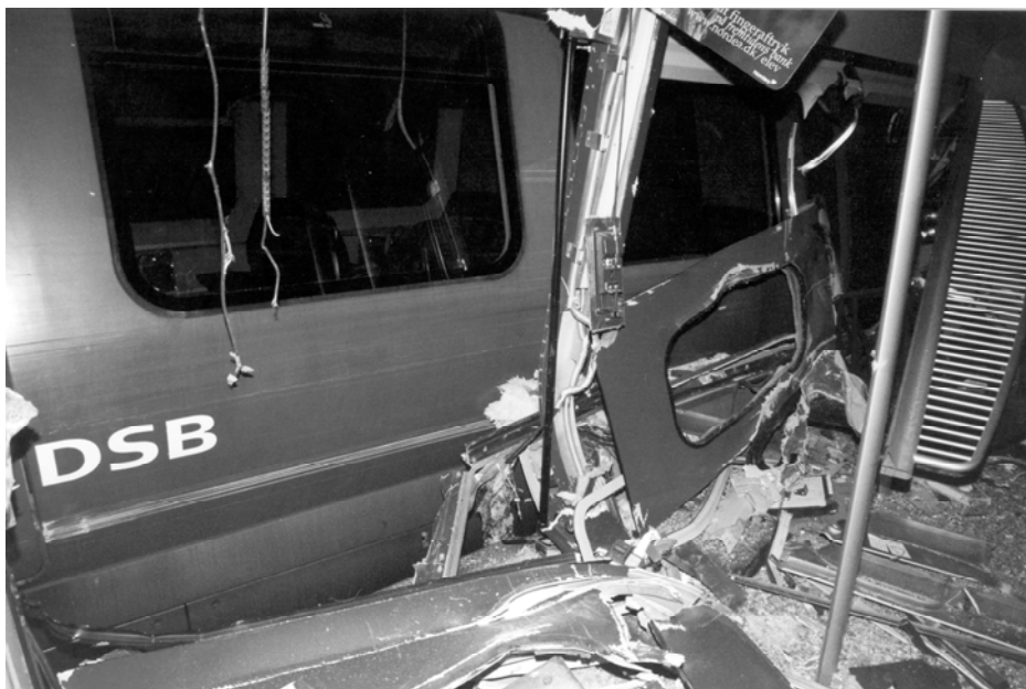
Forreste del (SA 8122) af toget i spor 21 (B+) – sidevæggen mangler helt
