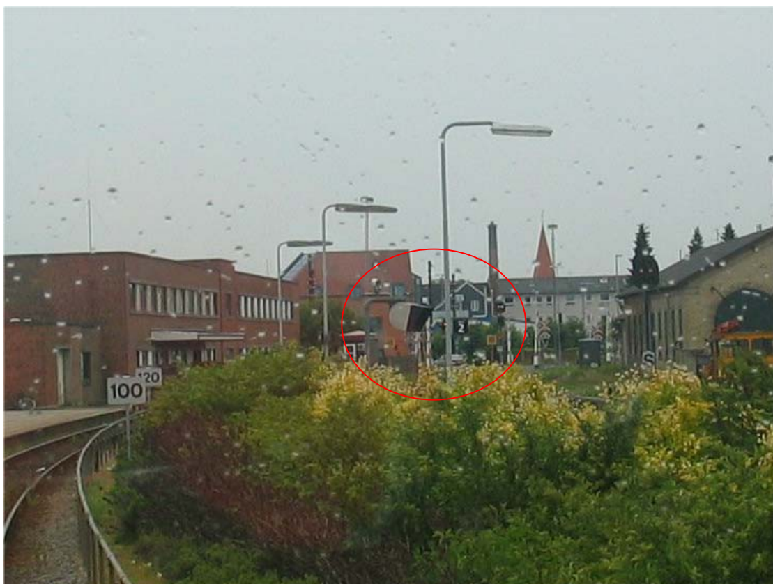
Figur 4 Udsnit af ovenstående. PU P12 er helt skjult; en lanterne i uordenssignalet kan ses, desuden kan PU for spor 2 ses til højre
