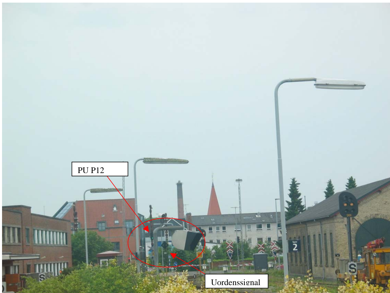
Figur 2 Udsyn fra spor 1 mod bl.a. PU P12, der er delvis skjult af monitorstanderen. Slukket uordenssignal ses mellem standeren og monitoren.
